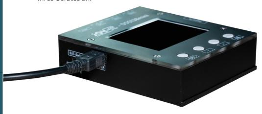
Nachdem Sie die Spannungsversorgung hergestellt haben, startet das Gerät automatisch. Alternativ zur microUSB-Spannungsversorgung lässt sich auch eine 3,7 V Lithium-Ionen-Batterie für den mobilen Einsatz verwenden. Weitere Informationen zum batteriebetriebenen Einsatz finden Sie in **Kapitel 6 - Anschluss einer externen Batterieeinheit**.
